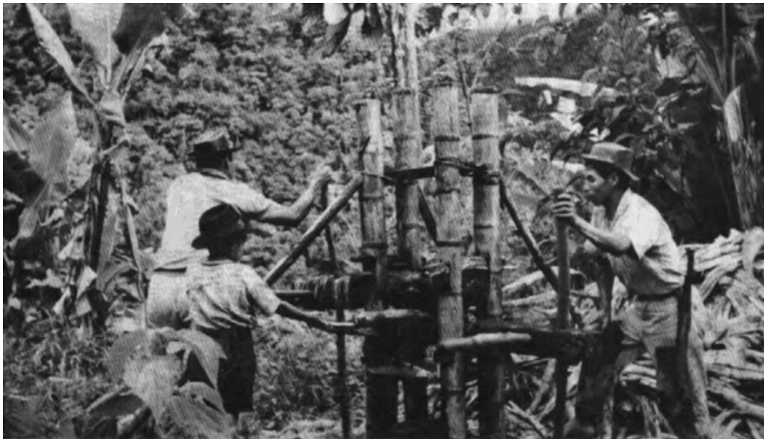
Foto No. 10. Trapiche de guadua y madera movido a mano entre dos
