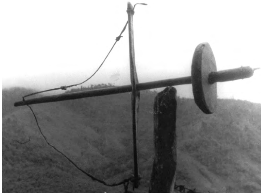
Foto No. 35: Taladro con punta hecha con una lima
